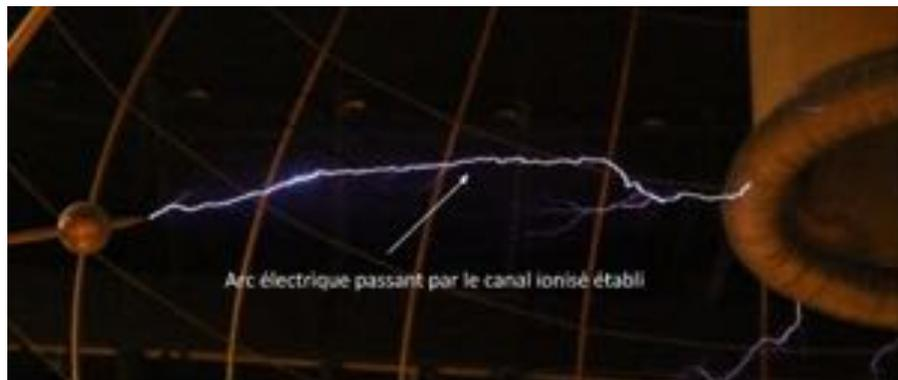
Photo prise par notre appareil photo réflex de l'arc électrique issu de la bobine Tesla [figure 6]
