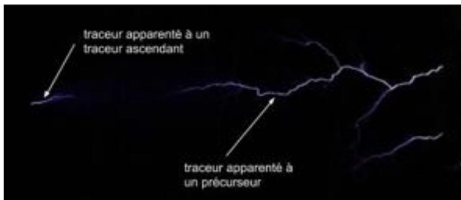
Photo prise par notre appareil photo réflex de l'arc en formation [figure 5]
