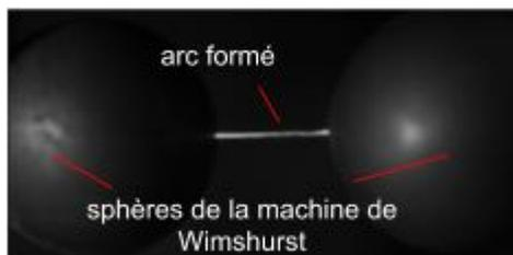
filmant l'arc à 25 000 images par seconde, nous avons obtenu une structure parfaitement rectiligne, loin des ramifications que l'on peut observer lors d'un éclair. De plus, sur un nombre d'essai important, nous avons constamment obtenu un arc identique, ce qui est contraire à ce que nous recherchions : chaque éclair est unique.
